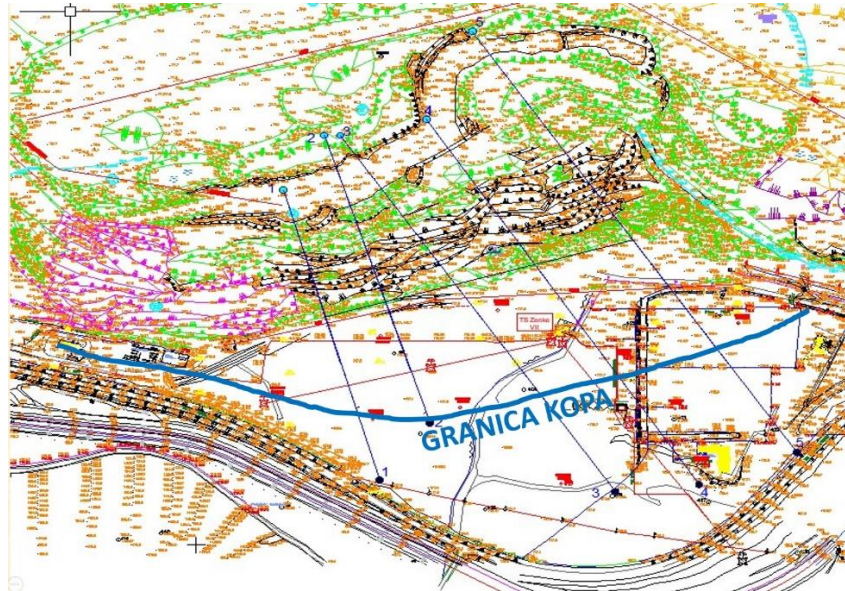
Slika 15. Položaj gornje ivice novodimenzionisane etaže (granice kopa)
