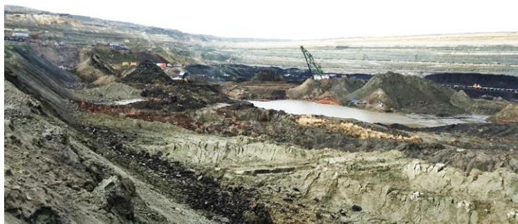
Slika 1. Vodosabirnik u podinskoj etaži uglja, 29.11.2022. [2]
