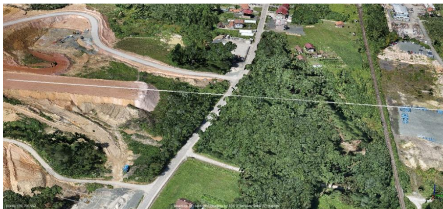
Slika 7. Pozicija prelaska transportera preko magistralnog puta i pruge
