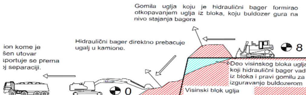
Slika 3. Tehnologija rada sa utovarom rastresenog materijala koji je izguravan sa krovine visinskog bloka i njegov utovar u kamione hidrauličnim bagerima
