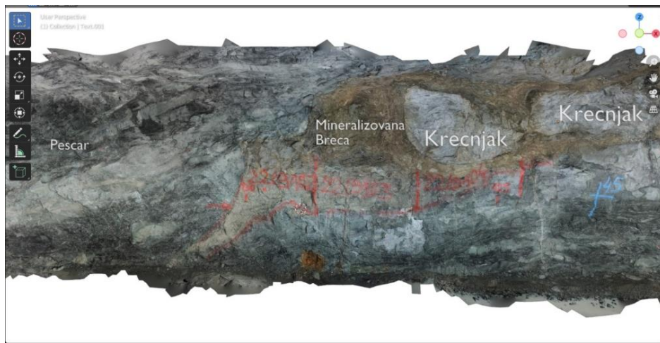
Slika 4. Modelovani deo hodnika GIH-200/JI nakon izrade i kartiranja.
