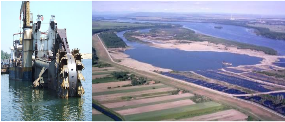
Slike 10 i 11. Podvodna eksploatacija na Rudniku Kovin - plovni rotorni bager (levo) i podvodno eksploataciono polje na pregrađenom delu Dunavu (desno) /foto dokumentacija Rudnika Kovin/
